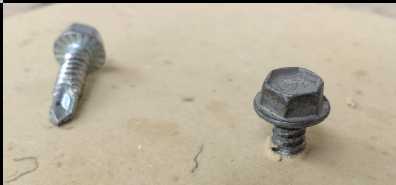
Ensayo de resistencia a la extracción del tornillo/ Tested resistance to screw extraction
