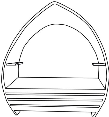
Funktionale Bank, hergestellt aus wiederverwerteten Materialien aus dem mittleren Teil eines Windradflügels. Leicht an Innen- und Außenbereiche anpassbar.
